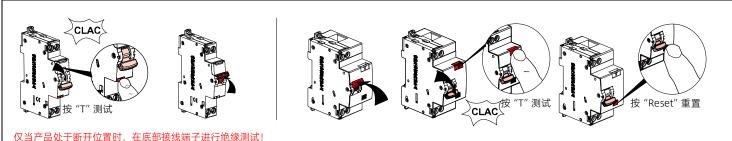
仅当产品处于断开位置时,在底部接线端子进行绝缘测试!
