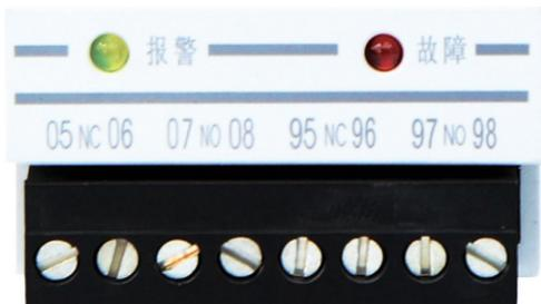
器动作，当热脱扣后，预报警LED灯熄灭，预报警继电器触头恢复原状态（即脱扣不报警），报警LED灯亮，报警继电器动作。（可考虑通过菜单来设置脱扣或报警）
