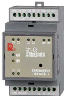
CI1系列远程智能I/O模块是一种简洁实用可靠的可通信监控模块，通过标准RS485接口、ModBus-RTU协议可实现系统的遥信、遥控及遥测功能。用户使用非通信型断路器时，可以通过该模块实现对相应配电回路的监测。用户能远程监测该回路电流、断路器合分闸状态、故障状态等重要的信息。
