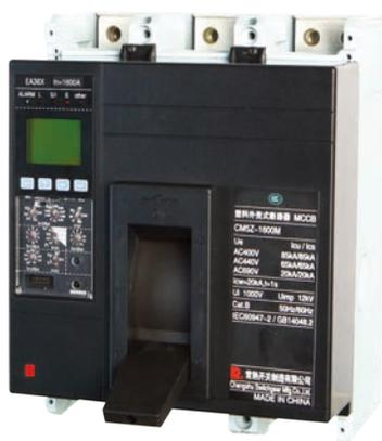
注：CM5Z-1600断路器脱扣器拨盘整定时箭头应对准刻度线而不能处于空档，否则断路器过电流保护可能失效。
