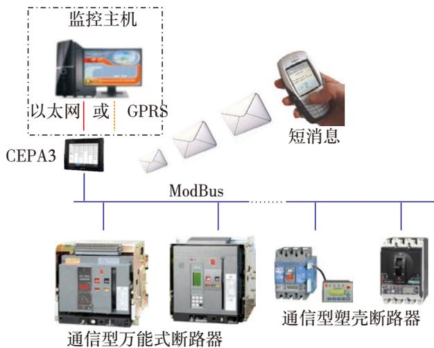
CEPA3是软硬件一体的产品，集监控主机、监控软件、数据采集器和Modbus TCP网关为一体，用户只需将我公司的智能化元器件与CEPA3相连接，然后经过简单的设置即可投入运行，实现“遥信、遥测、遥调、遥控”功能，用户无需编程也无需另外购买及安装软件。
