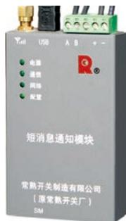
FDM3短消息通知模块采用标准RS485通信方式直接连接一台或多至16台可通信断路器，当断路器发生预先设置的事件时，通过GSM网络发送短消息到一部或多至10部手机提示用户及时处置，预设的事件可以是各种故障脱扣和电力参数异常报警。用户可通过我公司提供的计算机配置软件对短消息通知模块进行配置，包括通信参数、手机号码、设备名称、报警类型等，运行时无需计算机。
