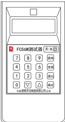
FCS6M 测试器采用 9V 电池（或电源适配器）供电，与智能脱扣器连接后实现对智能脱扣器的状态查询、参数查询、故障查询、参数设定等以及脱扣器之间的保护参数的复制，还可进行试验脱扣功能。通过该测试器可实现 E 型脱扣器热记忆的开或关、EM 型的断相保护开或关等。
