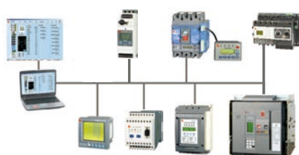
Riyea-PowerNet配电监控系统
