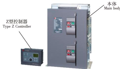
CAP1系列自动转换开关电器外形如上图，结构分本体和控制器两部分，其中本体包含电磁驱动部件和机械开关部件。本体有100、225、630、1600、4000五个壳架，控制器有基本型（J型）、电子型（E型）、智能型（Z型）、智能可通信型（ZT型）四大类，用户根据需要选择相应额定工作电流的开关本体及相应功能的控制器。本体和控制器两者用1.8m电缆（J型控制器为0.5m电缆，但2极产品J型控制器与本体一体）连接（电缆长度超过，用户在订货时注明）。
