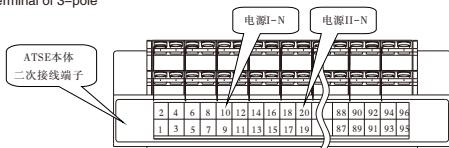
10: 电源I的N线接线端子；
