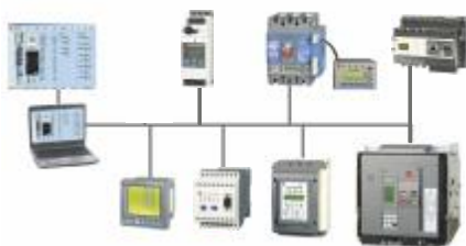
Riyar-PowerNet 配电监控系统
