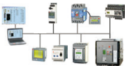
Riyeer-PowerNet配电监控系统
