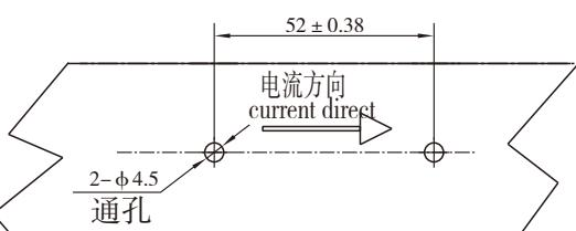
母排参考开孔尺寸 (使用配套螺钉)
