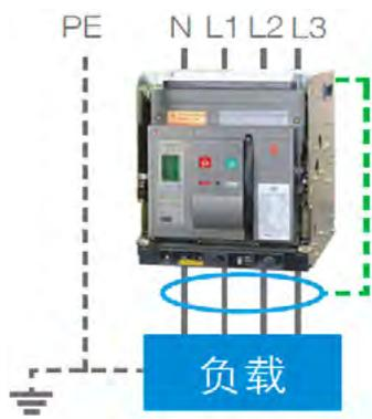
基于穿越3相及中性线的剩余电流互感器采样剩余电流信号，经EN37或EA37或ER37或EP37或EQ37型智能控制器处理后，判别故障电流并发出相应动作信号。
