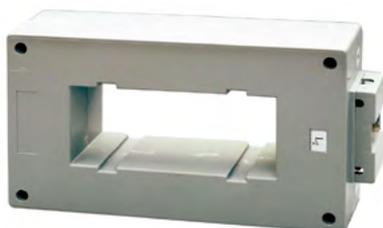
TN-S 配电系统中与三极断路器或四极断路器一起使用，安装于变压器低压侧中心点接地线上，电流采样信号经外接变压器中心点接地单元输入断路器 EN、EA、EP、EQ 智能控制器，作接地故障保护用。
