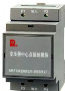
用于变压器中心点接地故障保护用，与外接变压器中心点接地互感器配套使用。P1、P3 接外接变压器中心点接地互感器，P2、P4 分别接断路器二次回路接线端子 48、50。此单元卡装于成套柜内 35mm 标准导轨上。
