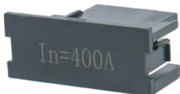
用户可根据配电系统的实际电流大小选择对应额定电流插头，降低断路器额定电流，以更好的对下级设备进行保护。额定电流插头安装于智能控制器正面，更换时需确保智能控制器 断电。
