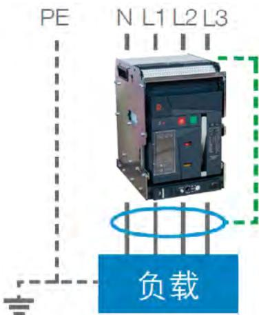
基于套装于3相及中性线的剩余电流互感器采样剩余电流信号，经TD67或TY67或TT67型智能控制器处理后，判别故障电流并发出相应动作信号。
