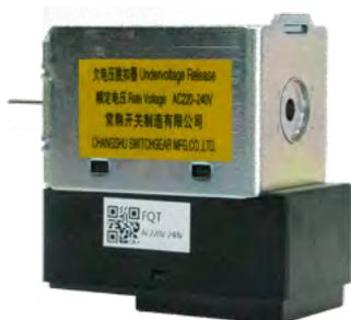
欠压脱扣器按动作时间分为瞬时动作和延时动作两种，延时动作的欠压脱扣器由瞬时动作的欠压脱扣器和欠压脱扣器延时模块组成。延时模块卡装于 35mm 标准导轨上，模块输入端接电源输入，输出端接至断路器二次回路 31、32 接线端子。
