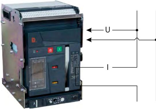
CW6 系列断路器常规配置的测量精度为电流  $\pm 1.5\%$ 、电压  $\pm 0.5\%$ 、功率 / 电能  $\pm 2\%$ ；用户也可选择性能等级 Class2：电流  $\pm 1\%$ 、电压  $\pm 0.5\%$ 、功率 / 电能  $\pm 2\%$  及 Class1：电流  $\pm 0.5\%$ 、电压  $\pm 0.5\%$ 、功率 / 电能  $\pm 1\%$ 。
