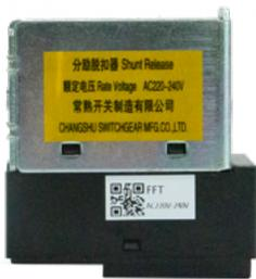
分励脱扣器可远距离使断路器断开，在施加一个持续时间不小于 200ms 的操作电压下，会将断路器立即断开。
