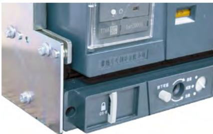
抽屉式断路器处于“分离”、“试验”、“连接”位置时，可拔出锁杆来锁定，锁定后断路器将无法摇至其余两外位置。挂锁用户自备，锁杆直径  $\Phi 4\text{mm}\sim\Phi 8\text{mm}$ 。
